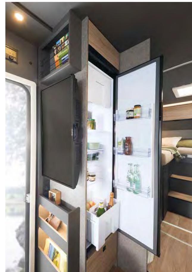
Le combiné réfrigérateur/congélateur de 137 l est surélevé pour un accès plus ergonomique. Doté du système AES, il sélectionne automatiquement la source énergétique la plus avantageuse (12 V, 230 V ou gaz).
