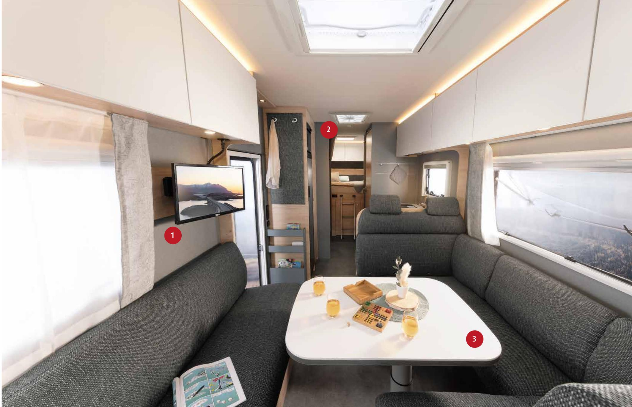
1 Il est possible d'installer un téléviseur (option) à une position ergonomique juste à hauteur des yeux. Les branchements pour l'alimentation électrique et le signal d'antenne sont déjà installés.
