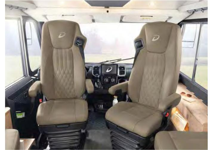
Sièges conducteur et passager SKA premium installés de série. En option, vous pouvez commander des sièges pivotants pneumatiques qui gommement entièrement les vibrations et coups transmis par la chaussée. Une option de chauffage et d'aération de siège est alors également disponible
