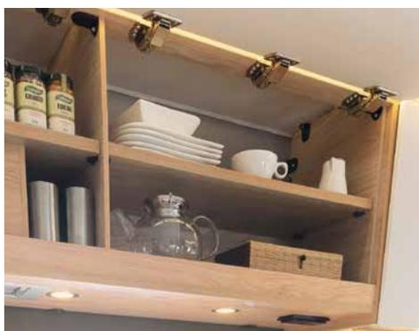
Les placards de pavillon réservent également de multiples espaces de rangement. Le système AirPlus de Dethleffs permet à l'air de circuler à l'arrière des placards de pavillon et prévient la formation de la condensation.
